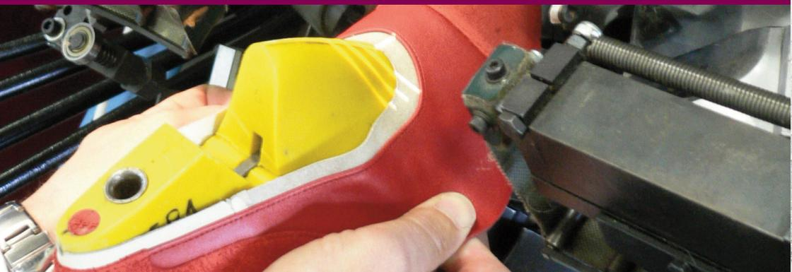
Le monteur réalise l'assemblage de la tige avec la semelle selon différents procédés : soudé, cousu.
